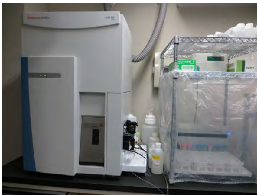
図83 マグマ変遷解析センターに設置された ICP-MS (iCAP RQ)。
